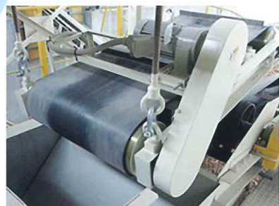
◀ベルト磁選機により釘などの鉄くずを除去
